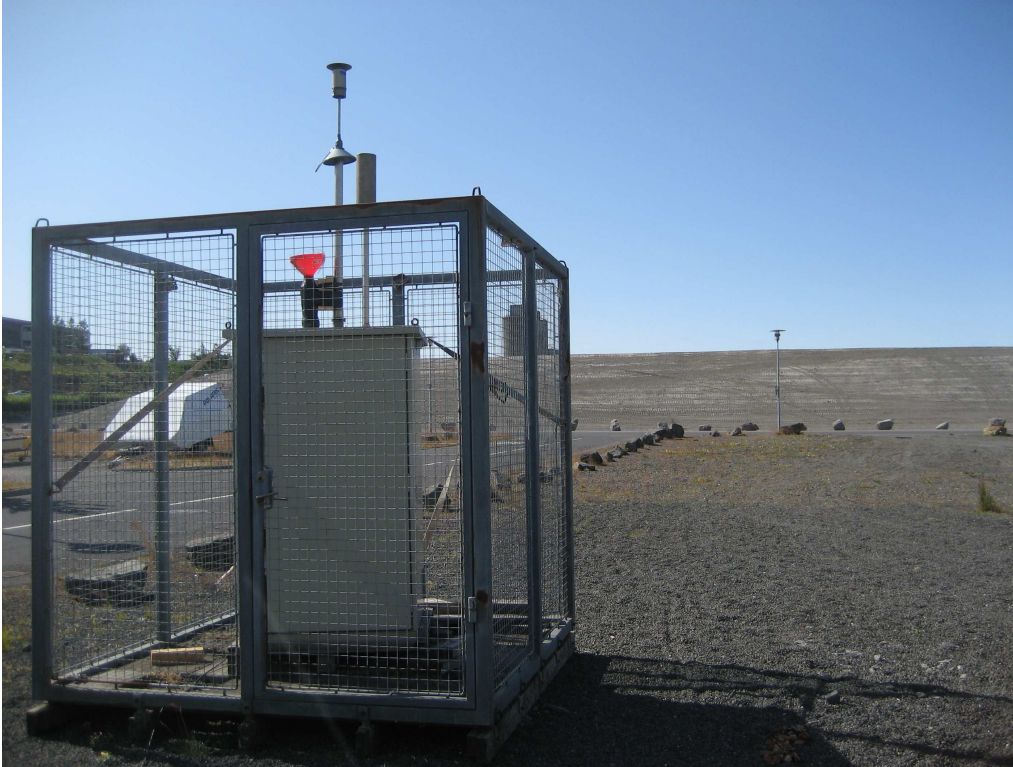
Mynd 2. Farstöðin staðsett á Naustabryggju. Ofan á farstöðinni er heimatilbúin flaska með rauðri trekt sem notuð var til að mæla fallryk (sjá einnig mynd nr. 3). Á myndinni má sjá vestan megin hvernig Björgun er búin að búa til einskonar vegg úr sandi í staðinn fyrir sanddyngjurnar sem hefur verið sáð í.
